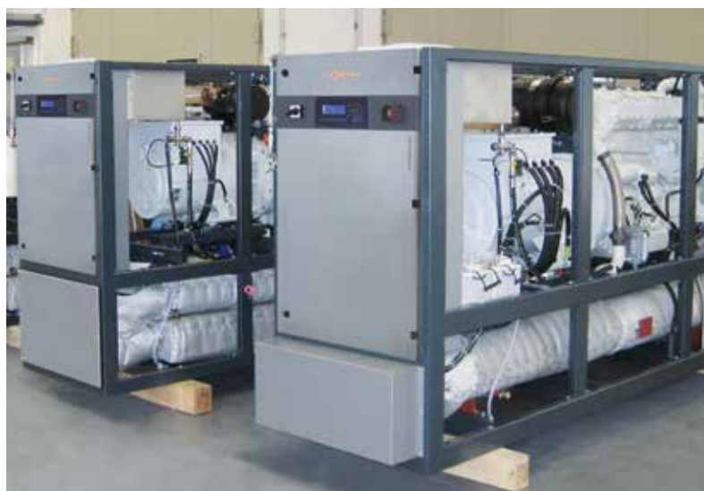
Prima della consegna i gruppi di cogenerazione vengono sottoposti a prove di funzionamento. Tecnici specializzati assicurano il perfetto funzionamento dell'impianto
